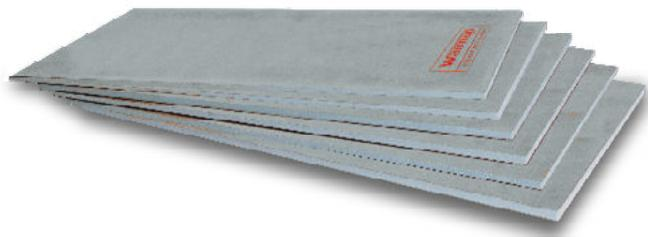
El panel aislante con revestimiento WIB de Warmup® es una lamina impermeable fabricada de poliestireno extruido, recubierta en ambas caras por una malla de fibra de vidrio insertada dentro de un mortero de polimero de cemento fino.
